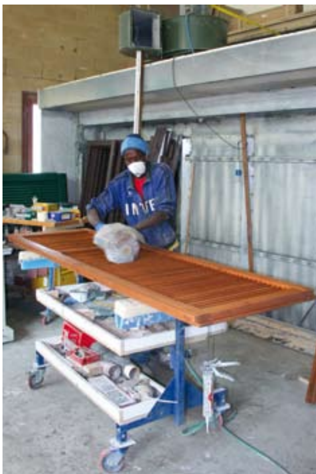
6 - La cabina a secco. Nel particolare, il girapezzi che permette di verniciare la seconda faccia del serramento.
