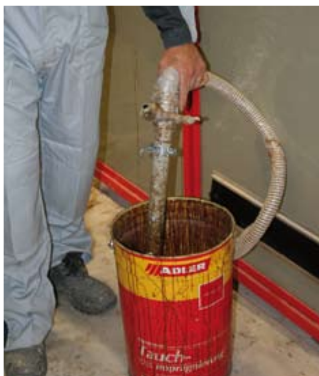
11 - Il pescante che, introdotto direttamente nel contenitore di vernice, carica nel flow-coating la quantità necessaria di prodotto.
