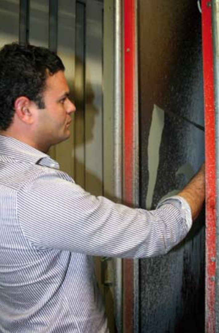
12 - Particolare della parete del flow-coating, interamente costruito con un materiale dielettrico antiaderente: si rimuove facilmente il film di vernice depositato. 12 – The wall of the flow coating machine, constructed on the inside with a non-stick dielectric material: the film easily comes away.
