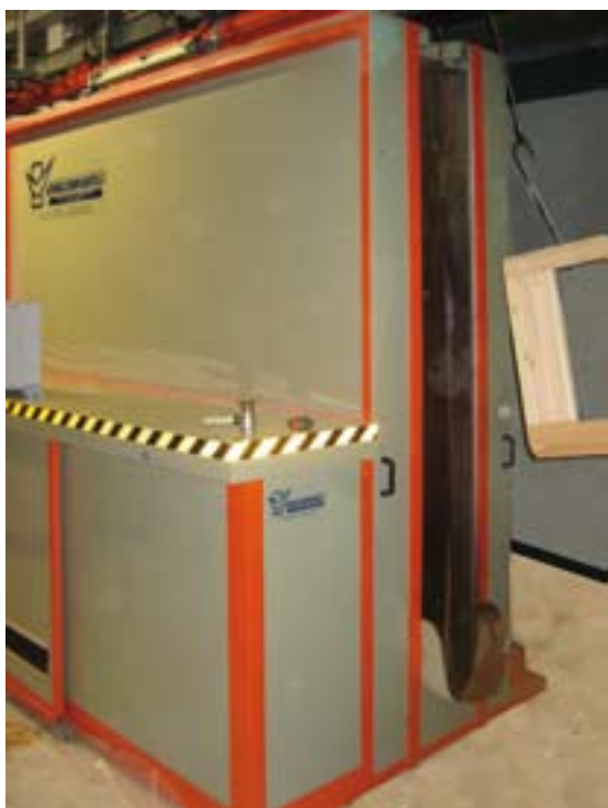
8 - Il flow-coating: si noti l'altezza alla base ridotta.
