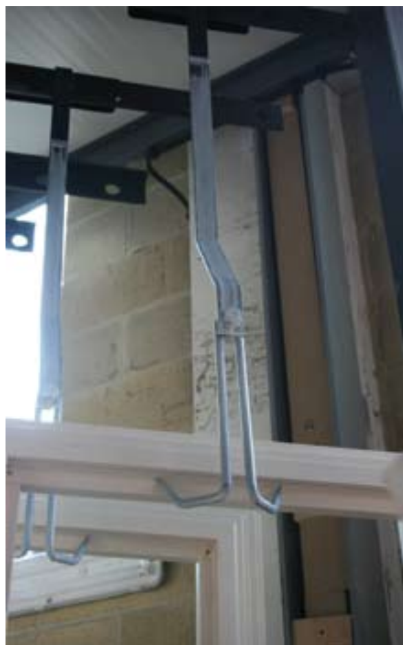
9 - Il gancio a doppio uncino: consente di posizionare al meglio il serramento in fase d'essiccazione, anche sull'angolo.
