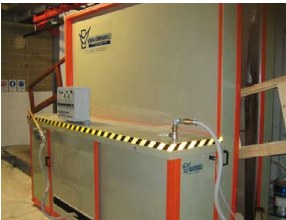
4 - Il flow-coating mobile, posizionato lungo la linea del trasportatore.
