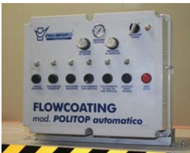
10 - Il quadro di comando del flow-coating consente di effettuare automaticamente tutte le relative operazioni, dal carico/scarico del prodotto allo svuotamento dei tubi verticali, e il lavaggio delle pareti interne.
